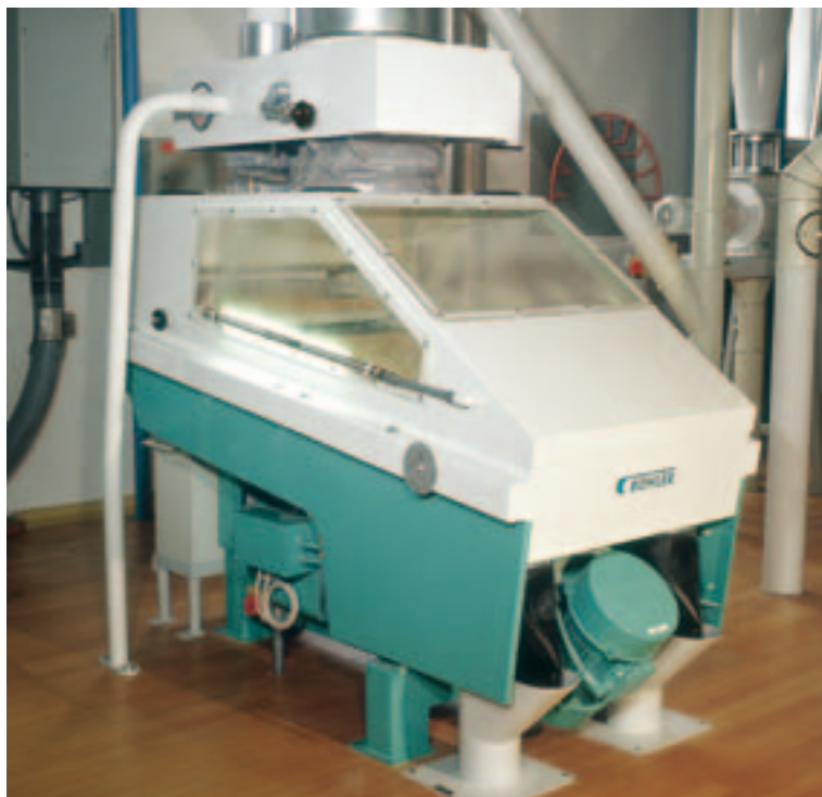
Deschinadora MTSD para una extracción eficaz de piedras.
